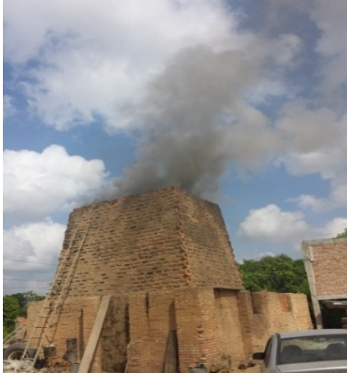
FIGURA 13. Horno ladrillero utilizando aceite quemado sin tratamiento.
